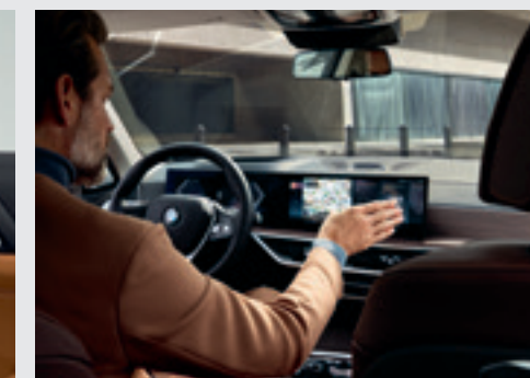
Commande gestuelle Commande de certaines fonctions par un simple geste au-dessus de la console centrale : réglage volume audio, accepter ou rejeter un appel téléphonique, fermer un fenêtre pop-up, confirmer un message Check-Control...
