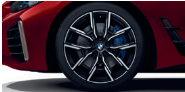
Jantes en alliage léger 19" (48 cm) style 859 M à rayons en Y, bicolors avec pneumatiques mixtes : Avant : 225/40 R19 - Arrière : 255/40 R19
