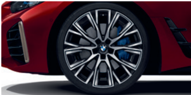
Jantes en alliage léger 20" (48 cm) style 862 I à rayons en Y, bicolors avec pneumatiques mixtes : Avant : 245/35 R20 - Arrière : 255/35 R20
